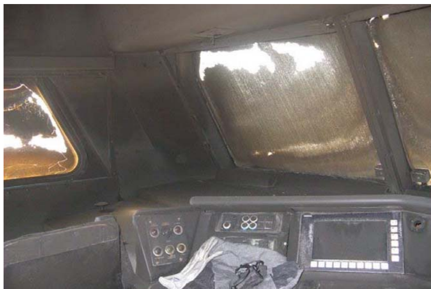
Estado de la cabina n.º 2 del tren 922 tras el incendio. (Fuente: Renfe Operadora).
