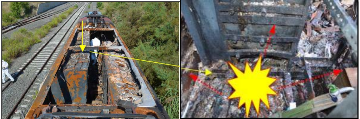
Zona de origen del incendio en el interior de la locomotora. (Fuente: HEFEST).
