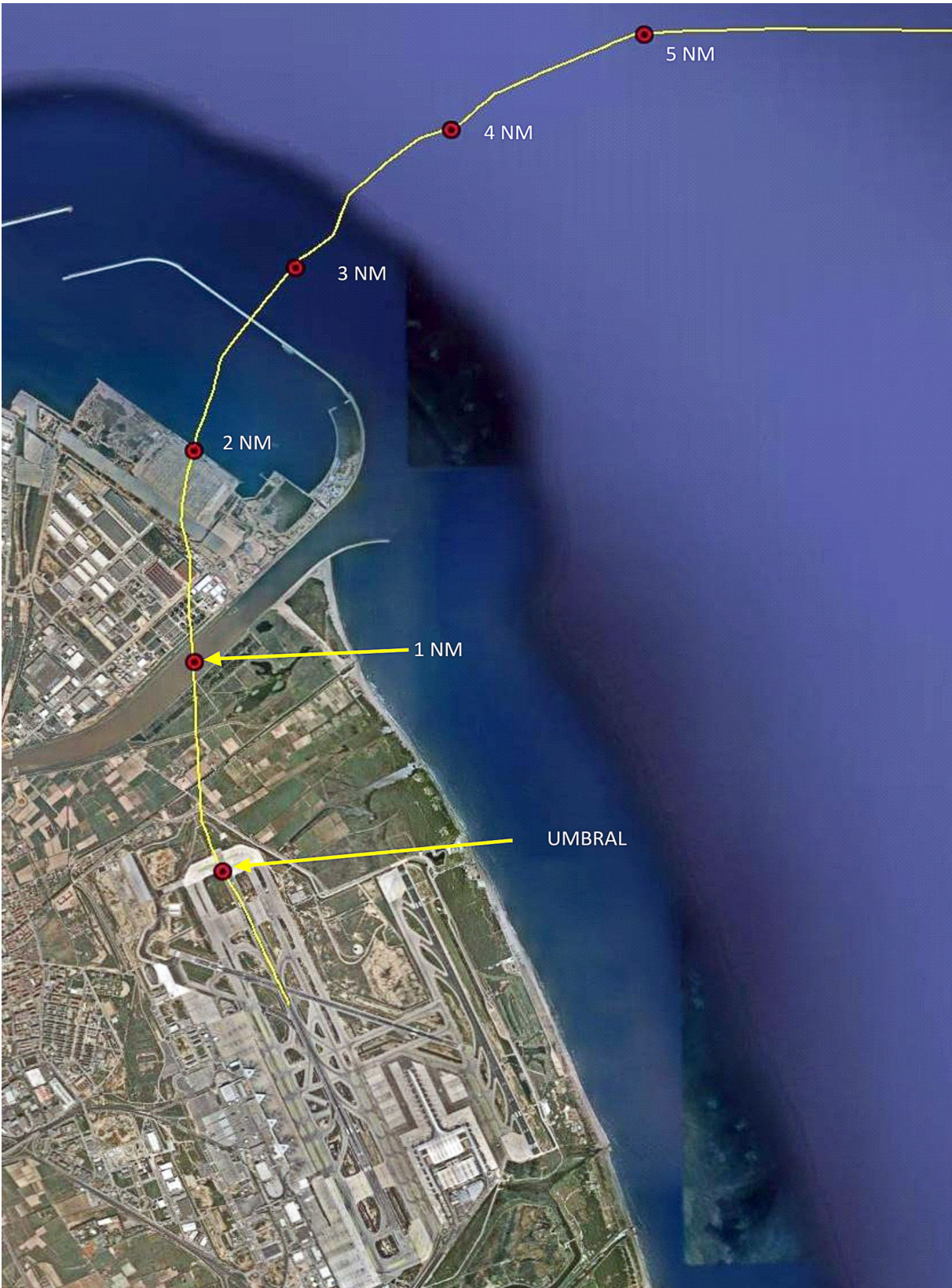
Figura 7. Planta de las últimas 5 NM de la trayectoria seguida por la aeronave. Las distancias indicadas son con respecto al umbral, y medidas sobre la trayectoria seguida realmente por la aeronave
