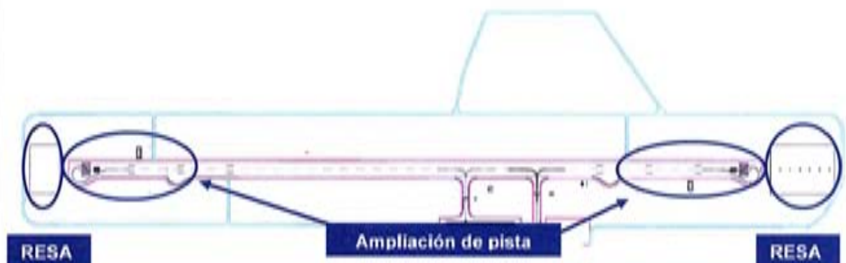
Ilustración 2.21.- Ampliación de pista
