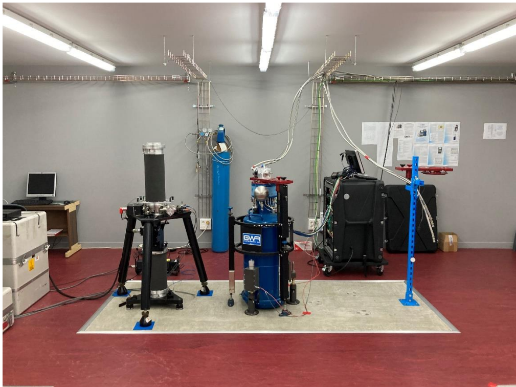
Gravímetros absoluto FG-5 y relativo superconductor SG del IGN en el Pabellón de gravimetría del Observatorio de Yebes (Guadalajara)
